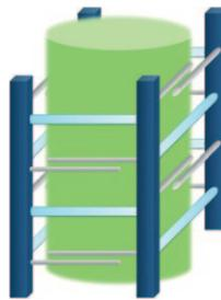
**Füll's auf!** Ein nanoporöses hybrides Zinkphosphat (siehe Bild;  $\text{Zn}_2\text{PO}_4$ -Säulen in Dunkelblau) mit in die Struktur integrierten organischen Liganden (Amin: grau; Arylcarboxylat: cyan) weist eine ungewöhnliche bimodale Porosität und Wasserstoffgas-Speicherfähigkeit auf.
